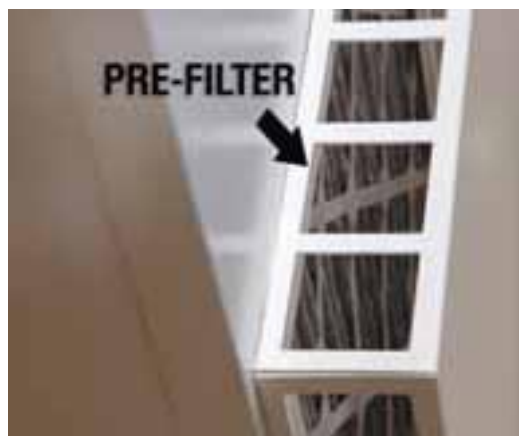
شکل ۲۴: ایجاد پرز بر روی فیلتر اولیه (پیش فیلتر) دستگاه هپا قابل جابجایی
