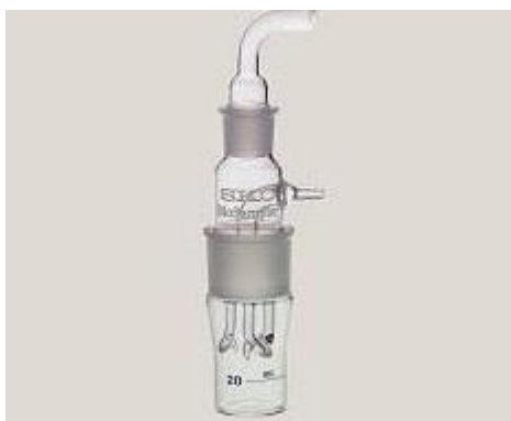
شکل ۲۱: بیوسمپلر مورد استفاده برای نمونه برداری بیوآئروسل (حاوی سه جت ایجاد کننده برخورد در سطح مایع)
